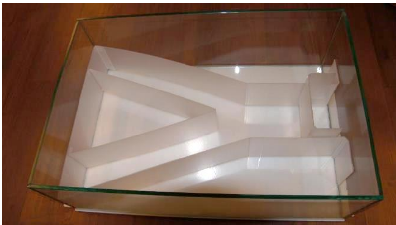
圖（二）主要實驗設備：玻璃大魚缸及 Y 型水道的設計
