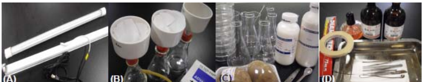
圖四 實驗器材 (A)LED 及專用 T8 空抬 (B)過濾裝置 (C)培養基配置用 (D)消毒滅菌及種菌用
