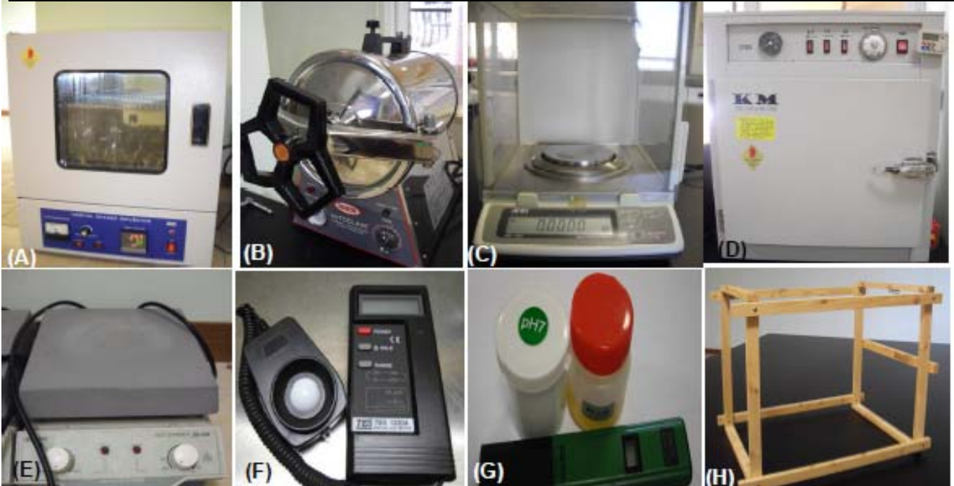
圖三 實驗儀器設備 (A) 控溫震盪培養箱 (B)高壓蒸氣滅菌釜鍋 (C)四位數精密電子分析天秤 (D)烘箱 (E)電磁攪拌器 (F)數位光照計 (G)pH 計 (H)自製木製 LED 燈架。
