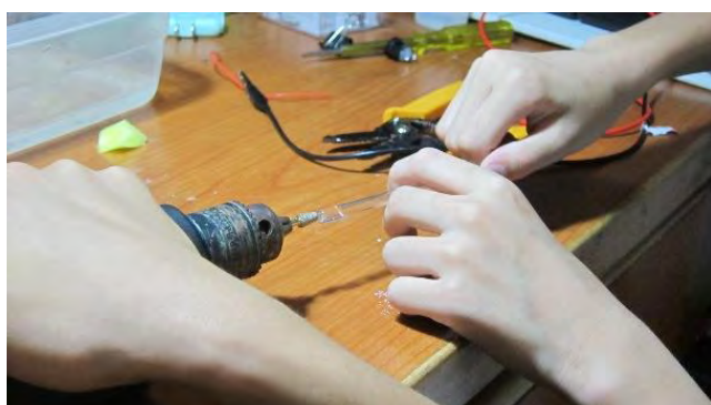
圖 14-1 玻璃噴射管加工
