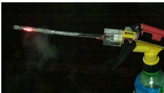
圖 14-3 第三代噴射測試(塑膠管融化)
