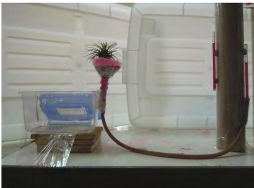
(圖三) 小精靈鳳梨根部吸水實驗裝置
