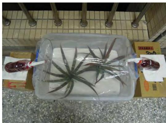
(圖十二) 金鑽鳳梨葉子吸水實驗裝置
