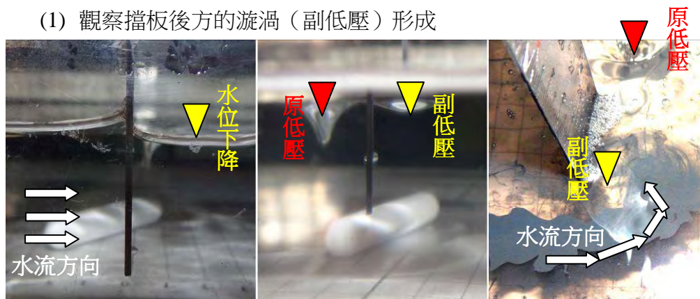
圖二十三、以直尺作為擋板模擬背風側副低壓形成：左：背面水位下降；中：背面產生漩渦；右：浮水印
