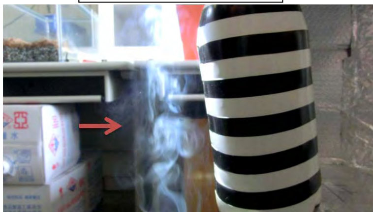
圖 43 熱源靠近，煙有環形擾動的現象
