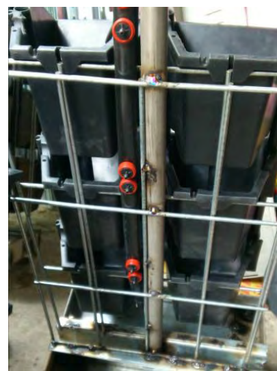
圖 5-8 簡易 PE 管給水系統完成圖
