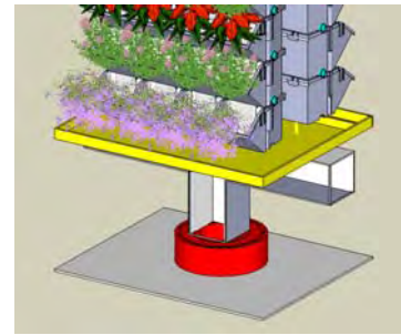
圖 4-22 植生牆底部集水槽
