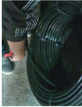
圖 4-36 剪取所需 PE 管長度
