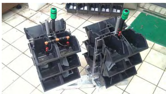
圖 6-1 植生牆轉軸式支撐系統裝置
