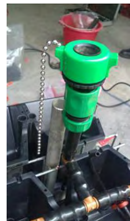
圖 4-43 頂部 PE 管連接快速接頭
