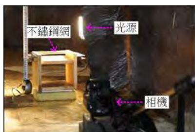
不鏽鋼網防濺測試
