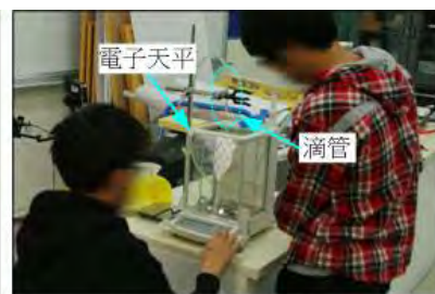
使用電子天平測定水滴質量
