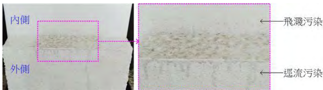
圖12 測試出現明顯的飛濺污染與逕流污染
