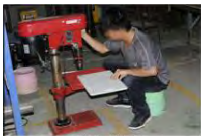
水槽底板鑽孔
