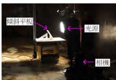
傾斜角度防濺測試
