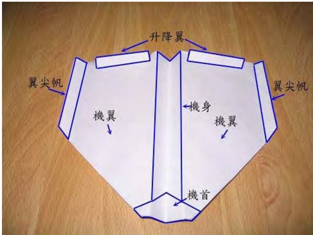
圖 3-1：飛機各部構造名稱示意圖
