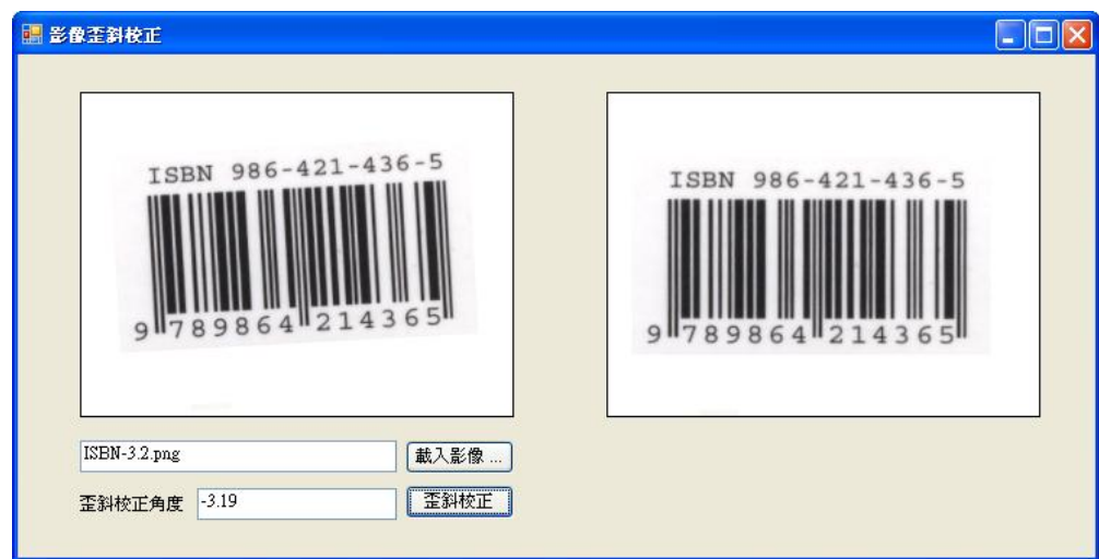
圖 6 利用霍夫轉換計算出條碼歪斜角度並將之校正
