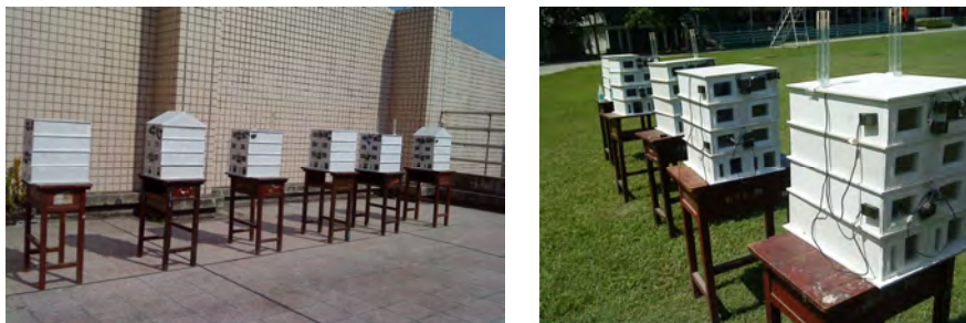
圖 12 房屋模型實地測試
