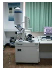
圖 6 電子掃描式顯微鏡及 能量分散光譜儀
