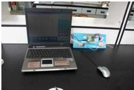
圖四十一、生質酒精燃料電池進行電力試驗示意圖
