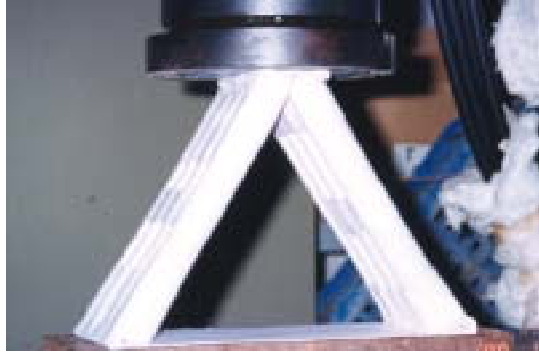
圖 5-10 萬能試驗機試驗過程（圓形）
