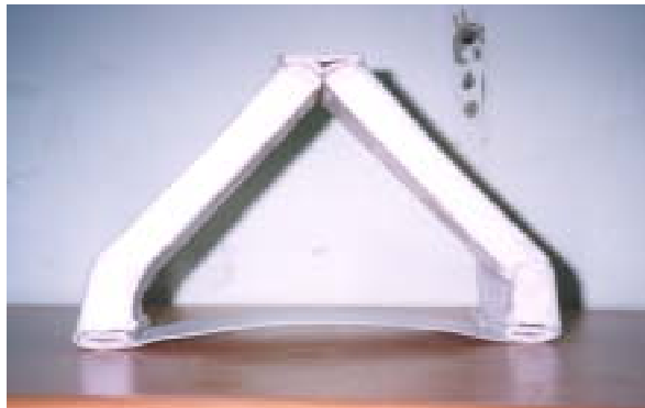
圖 5-11 萬能試驗機試驗後破壞狀況（方形）
