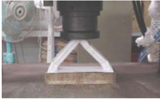
圖 5-13 萬能試驗機試驗後破壞狀況（三角形）
