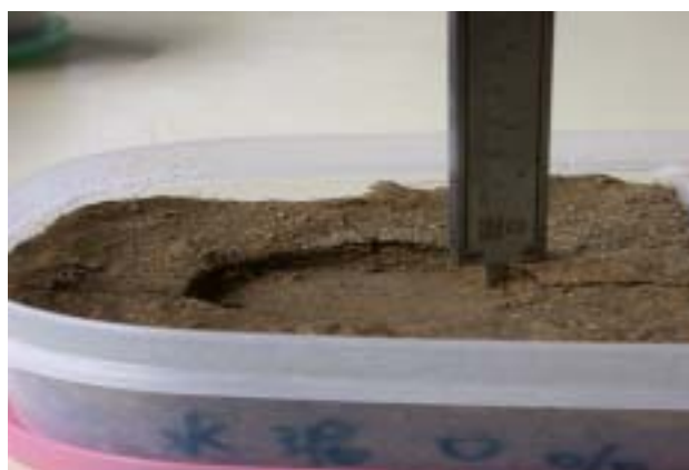
圖 6-2 以游標尺量測沉陷值
