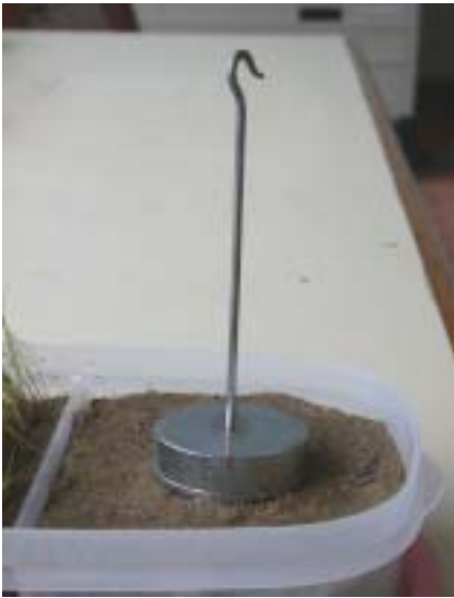
圖 2-1 落錘試驗裝置
