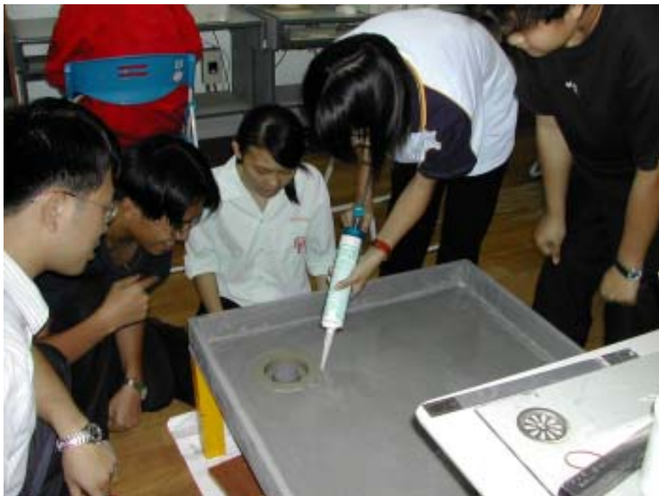
利用矽利康填縫使溝槽與工作平台密合
