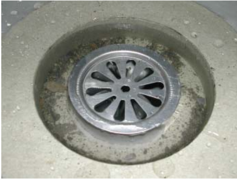
實驗後，溝槽裡泥沙沉積的情形
