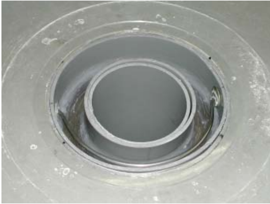
將固定式溝槽換成活動式溝槽
