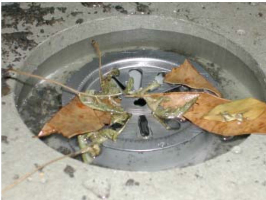
實驗後，樹葉覆蓋平頂式落水孔蓋的情形
