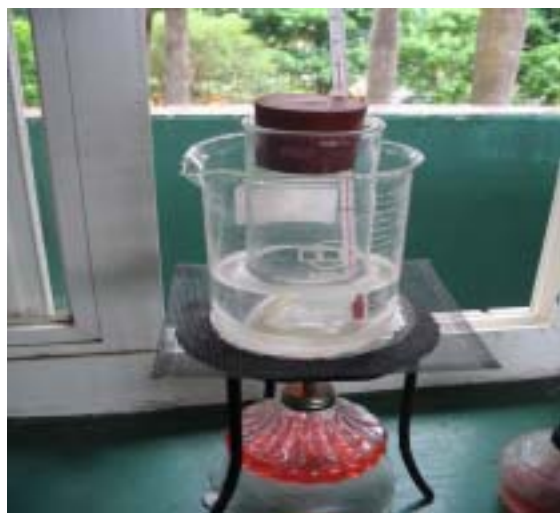
圖五（隔水加熱）
