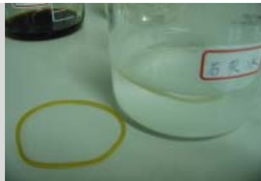
圖十（石灰水 - 表面有白色突起，變硬）
