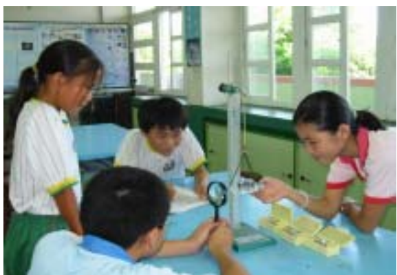
【固定重量的拉力下，測量橡皮筋的伸長量】
