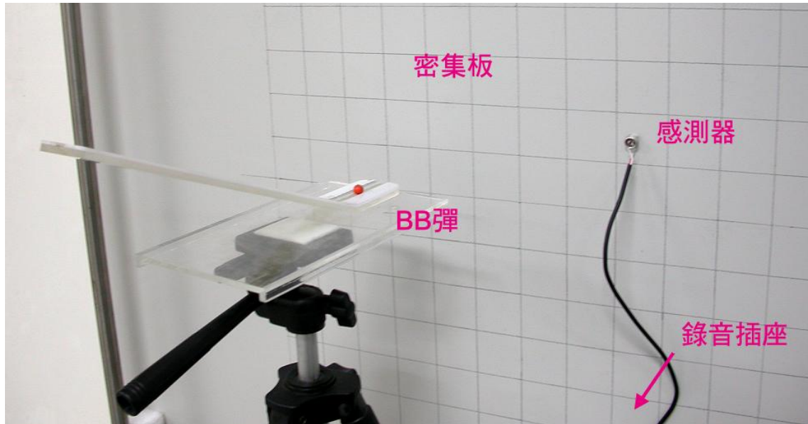
圖 7 感測器聲波記錄測試裝置
