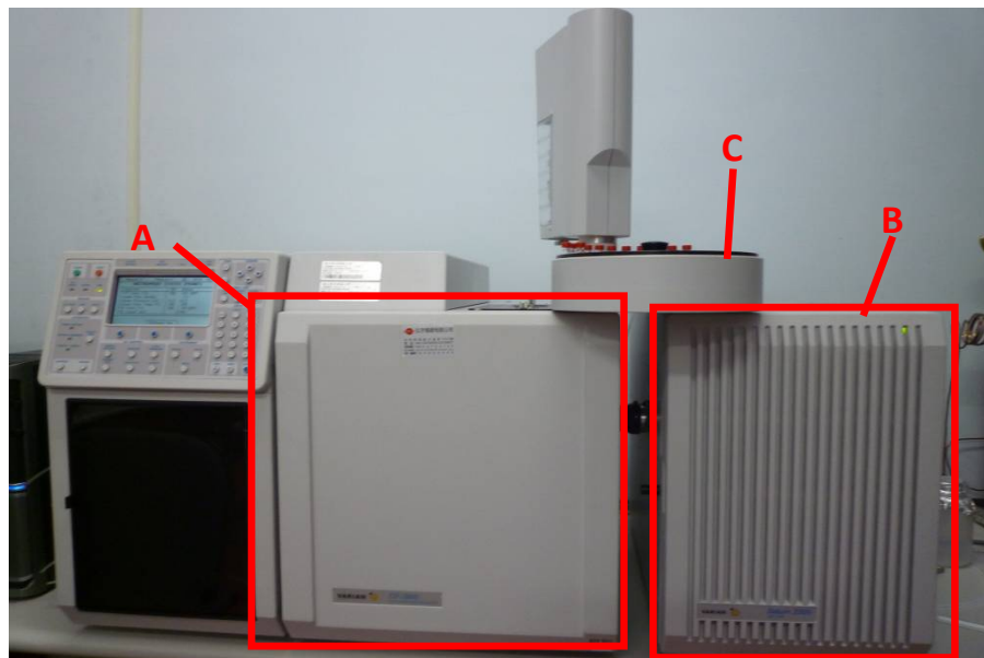
圖七、氣象層析質譜儀。(A、氣象層析儀 Varian CP 3800，B、質譜儀 Varian Saturn 2200，C、vial
