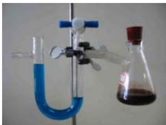
圖九：甲醇與高錳酸鉀反應產生之氣體，使 U 型管內水柱有明顯的高度差。
