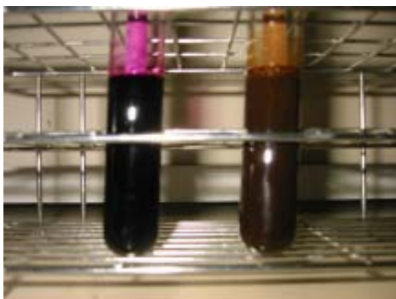
圖六：甲酸(右)立即與高錳酸鉀反應，溶液由紫色變為棕色，且快速產生氣體；反之，乙酸(左)數小時後仍無明顯反應。
