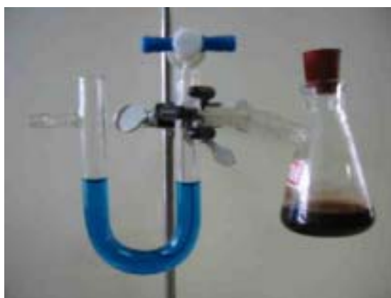
圖十：乙醇與高錳酸鉀反應只產生些微高度差，推測為水與醇類蒸氣造成。
