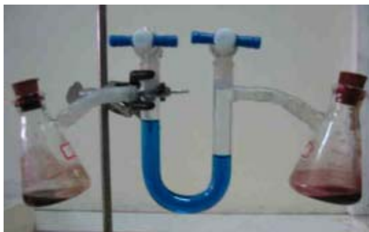
圖十一：高錳酸鉀在比壓裝置下與甲醇(右)、乙醇(左)反應，甲醇邊產生較大的壓力。
