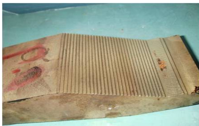
圖二十六、階梯斜面長 1.5 mm，階梯高 0.7 mm
