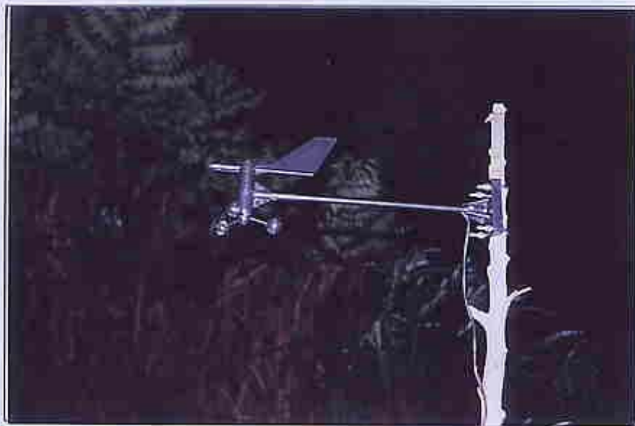
【照片 3】本次實驗用的風速計
