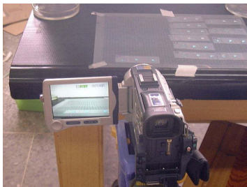
以數位攝影機拍攝三滴不同載液面的液滴側面，以比較不同載液面高度大小
