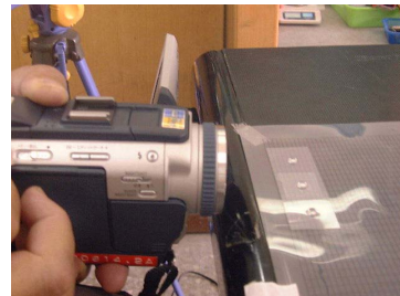
以數位攝影機拍攝三滴不同載液面的液滴側面，以比較不同載液面高度大小
