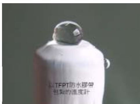
照片(六) 一滴水滴在包了防漏膠帶的溫度計上
