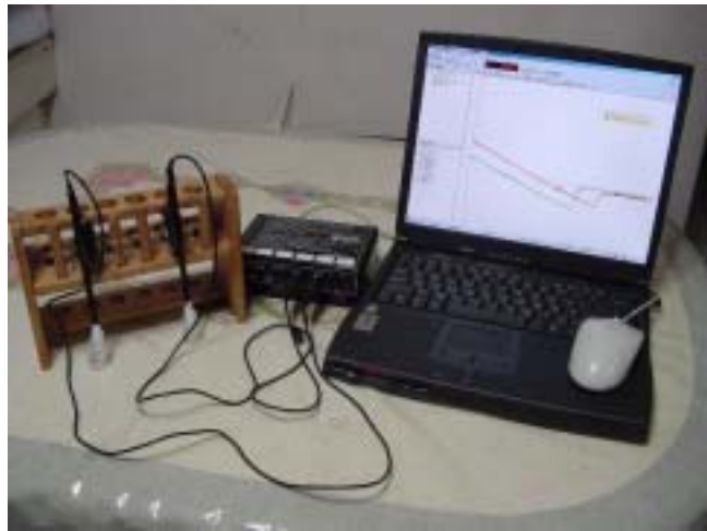
照片(三) 以防漏膠帶包紮溫度計測量裝置
