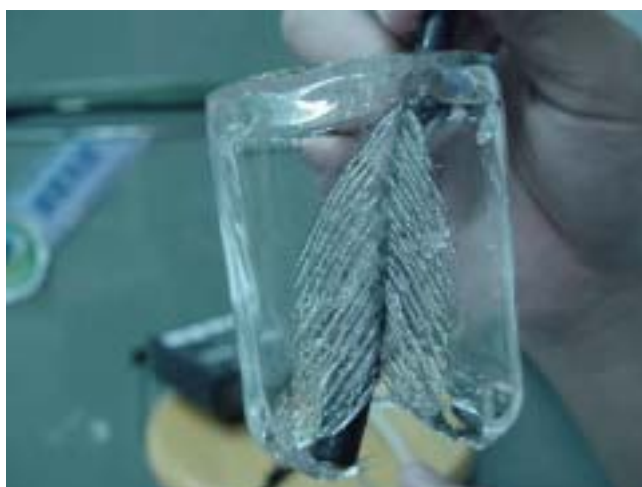
照片(二) 冰的晶體從溫度計表面開始長出
