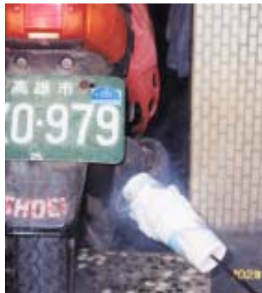
圖 10 紙口罩實驗時所冒出的濃煙
