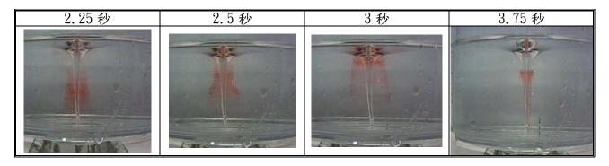
(2) 長 30 cm 寬 20 cm 高 20 cm 的有孔方形容器,觀察反漩渦的現象:(從第 1 秒 開始每隔 0.5 秒錄 1 個圖)
