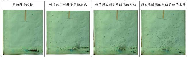
(3)利用有孔圓形容器,以針筒(不加針)從下方灌入染色的洗髮精,在容器上方中間位置製造水流:
