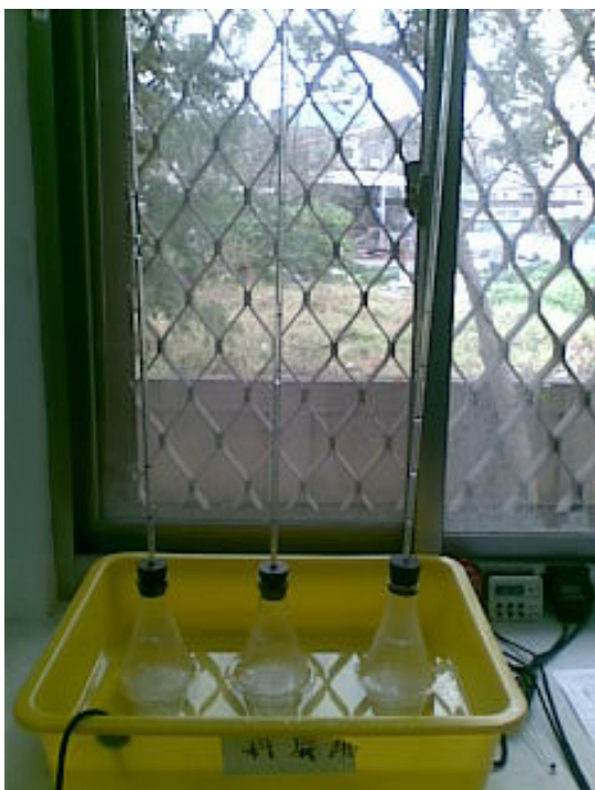
圖五，錐型瓶、空心玻璃管與橡皮塞組合起來後的情形。塑膠盆中為 30°C 的溫水，裡面有加溫棒保溫
