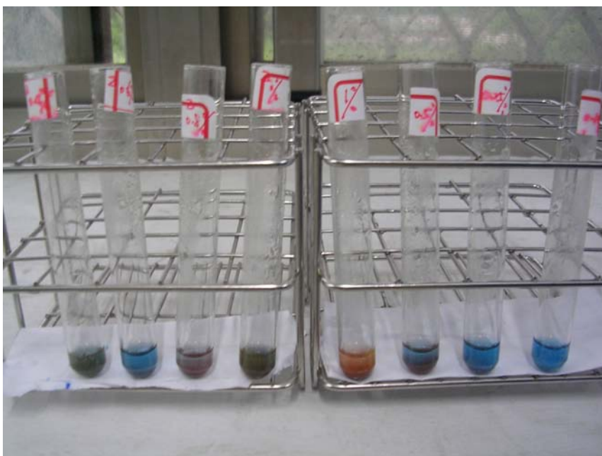
圖十九，北極磁極磁場處理的酵母菌液在30° C經過140分鐘後糖度的變化。(圖中右側葡萄糖液濃度由左到右分別為1%、0.5%、0.25%、0.125%。圖中左側為酵母濾液由左到右稀釋成0.04、0.06、0.08、0.1倍)
