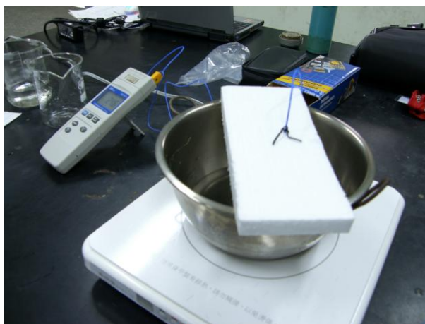
圖 5.2.1 比熱值的測定裝置(電磁爐 不鏽鋼鍋 數位式溫度計)
