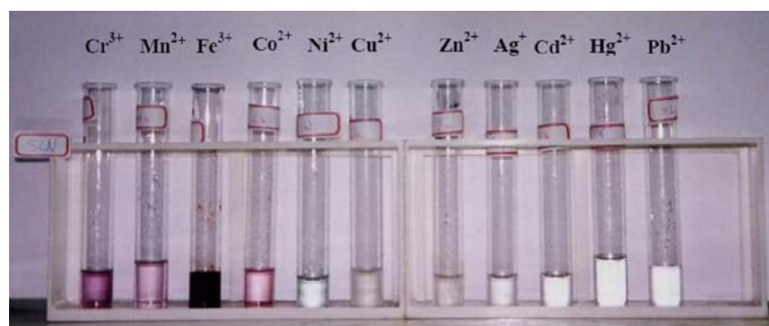
圖五 重金屬離子(1000 ppm)與硫氰化鉀(1.0M)反應的顏色變化
