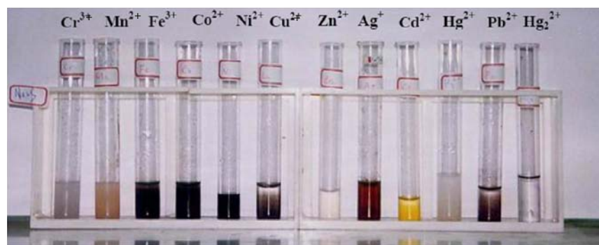
圖六 重金屬離子(1000 ppm)與硫化鈉(1.0M)反應的顏色變化
