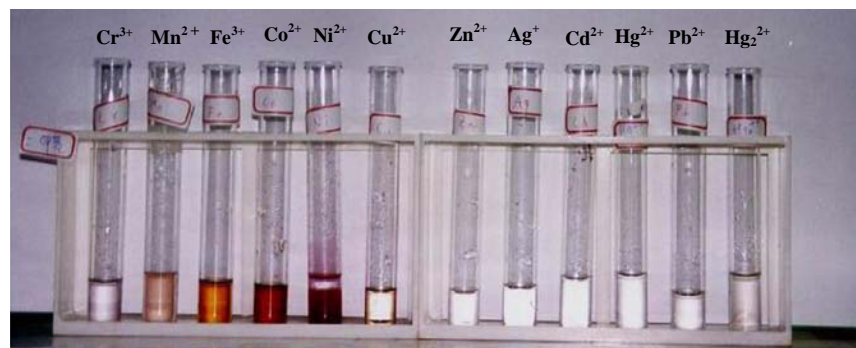
圖七 重金屬離子(1000 ppm)與二甲基乙二醛二肟(0.05M)反應的顏色變化
