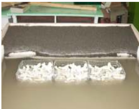
長 54cm 離岸堤經波浪沖蝕後的情形
