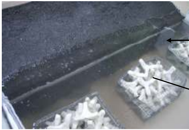
波浪經三座離岸堤沖蝕沙灘的情形
