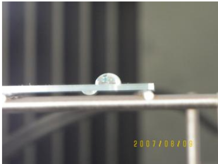
圖十五：經美工刀劃過 10000 次的結果，由照片可知變化不大。
