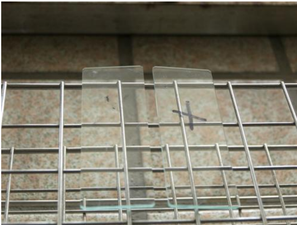
右邊是未處理的載玻片，左邊是處理過的，以油性筆測試，可知處理過的玻璃不易附著顏料。
