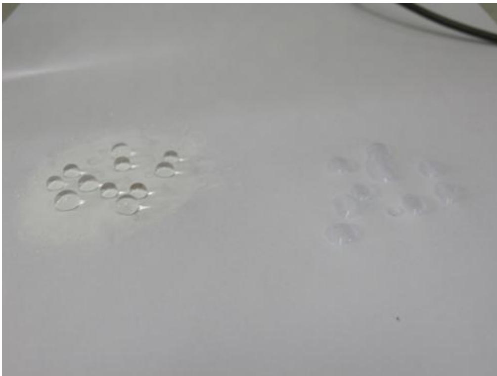
左方為超自然粉體處理過的 A4 紙表面，可知具有超高接觸角。
