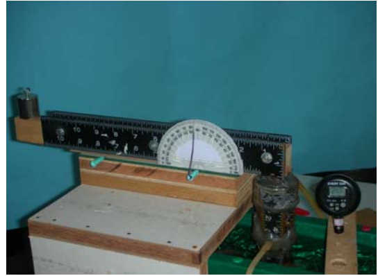
圖 10：第三代裝置以量角器觀察滾針旋轉
