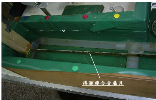
圖(20)：複合金屬片的固定及加溫裝置
