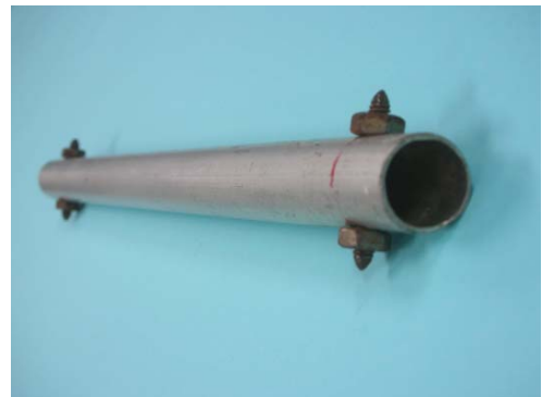
圖 5：金屬管兩端各鎖緊一段螺絲
