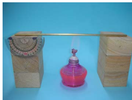
圖 2：第一代簡易熱膨脹儀
