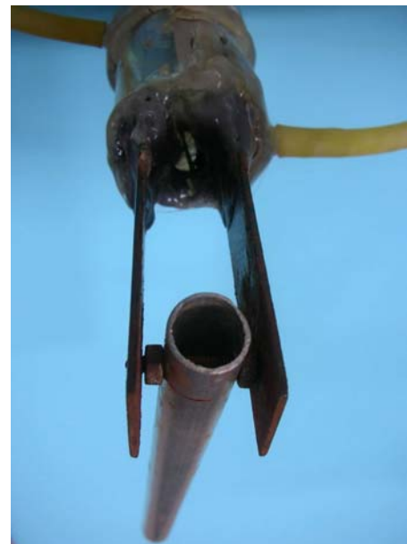
圖 8：以懸吊臂夾住金屬管
