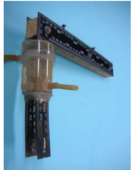
圖 7：角尺懸吊臂及隔熱裝置
