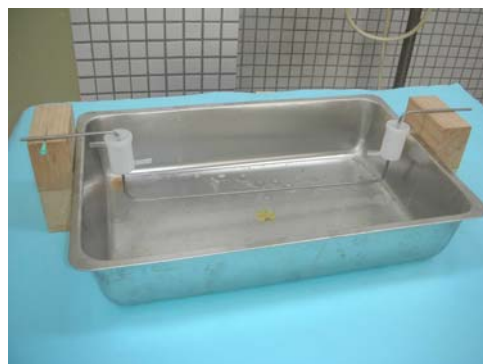
圖 3：第二代熱膨脹儀
