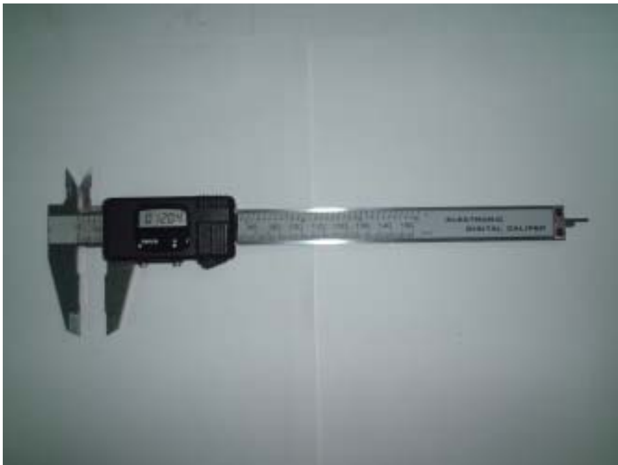
附圖十八：電子游標尺（準度公釐下一位）
