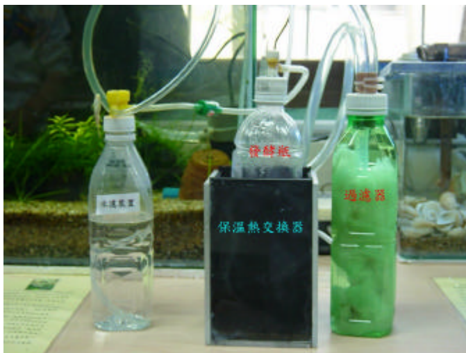
附圖十一 整合型水族養殖系統實體圖
