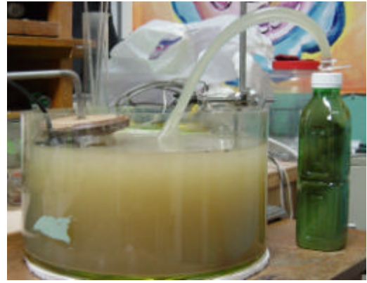
附圖八 過濾器性能測試（自製外循環式 / 實驗組）
