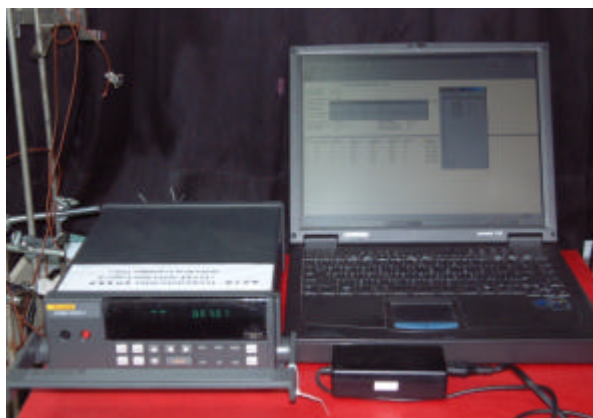
附圖五 溫度監控裝置 (FLUKE 2620 datalogger)
