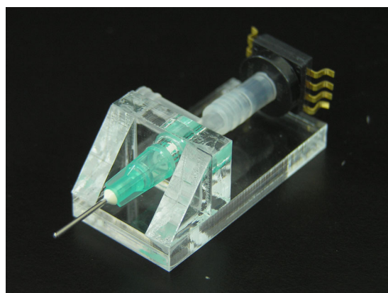
圖 29 針頭後面連接壓力感測器
