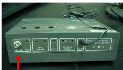
pH電極用電位計的BNC電壓輸入端子
