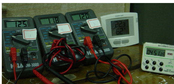
圖 3 測量倒入水之水溫
