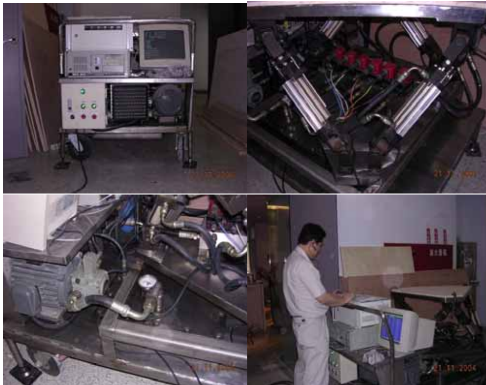
三軸向六自由度動感平台，及控制操作方式。(爸爸在右下照片)
