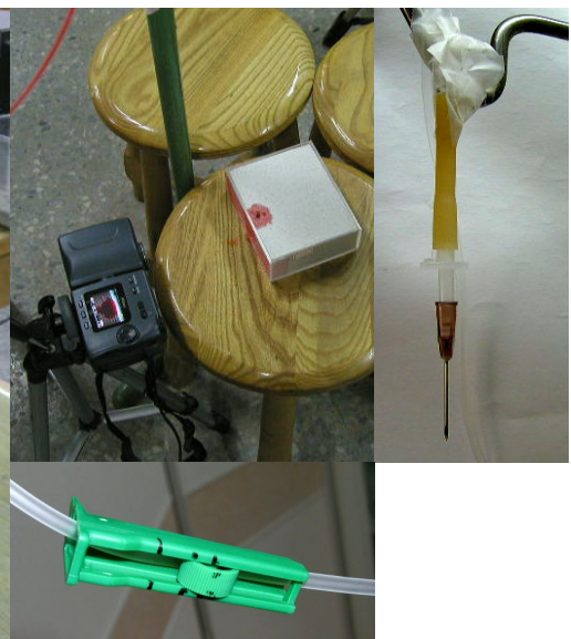
↑ 局部放大圖 (左上) 實驗拍攝儀器 (右上) 定率 針頭 (左下) 控制速率的調整器
