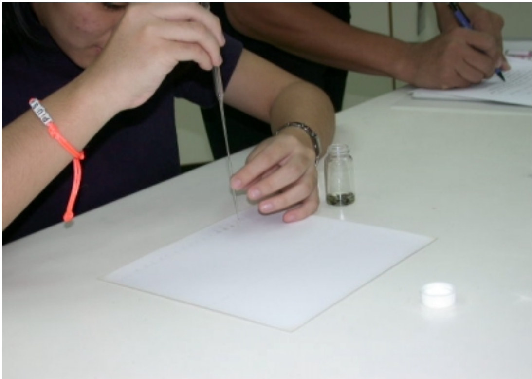
彩圖三十二、用滴管滴下地衣萃取液於矽膠薄板上
