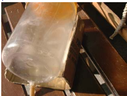
4 出口端夾緊後以抽氣筒抽氣減壓很快出現筒壁大量的霧氣
