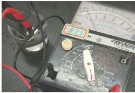
以三用電錶測各不同濃度的鹽水電阻大小
