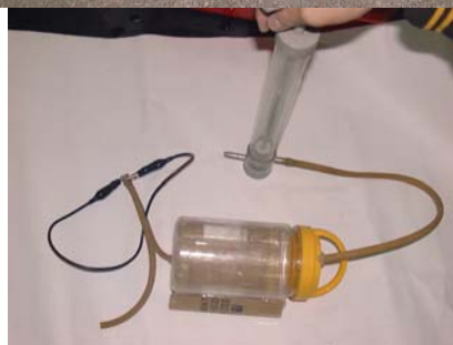
2 以抽氣筒試抽此蒸餾筒的密閉效果
