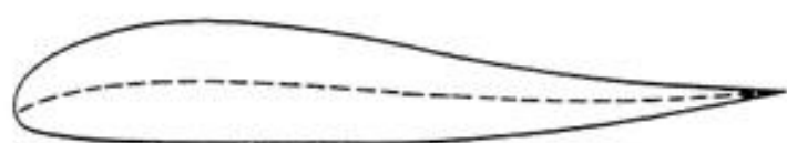
Reflex翼型（中間的虛線表示camber line）
