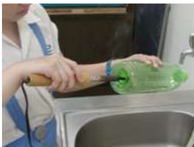
圖四：寶特瓶底部用焊槍融化出一個洞
