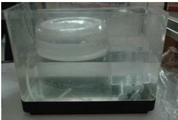
將反應管吐出的氣體收集到塑膠桶中
