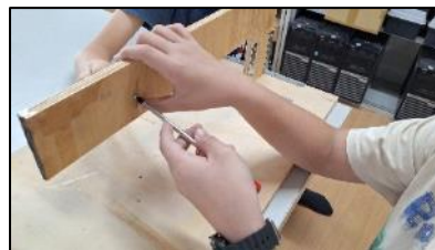
圖 6-7 將熱熔絲固定於底座及 支架之間 (作者自行拍攝)
