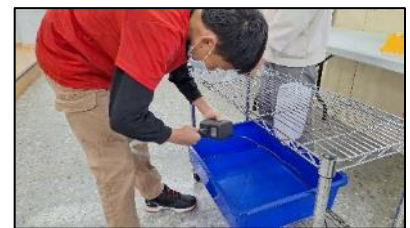
圖 6-14 連接馬達及水壓測量模組 (作者自行拍攝)
