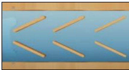
圖 3-1 「改變流體速度的通道－特斯拉閥」 作品使用之特斯拉閥 (引自吳庭光等人 [4]，第 7 頁，圖 10)
