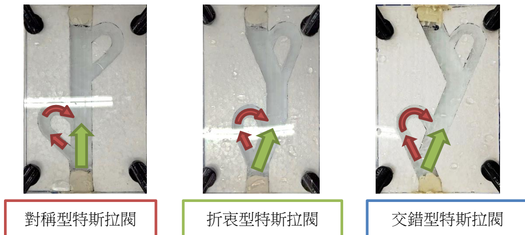
圖 7-10 不同主水道形狀之水流狀態示意圖 (作者自行拍攝與製作)
