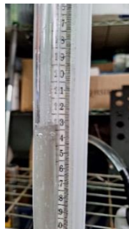
圖 3-3 本研究運用托里切利實驗原理設計之 水壓測量模組 (作者自行拍攝)
