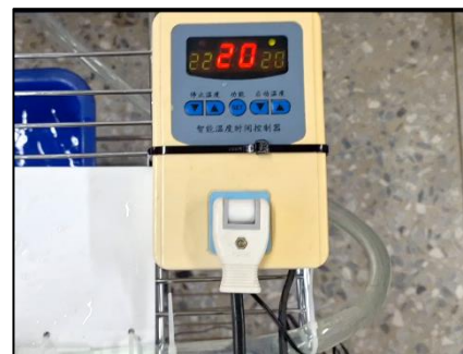
圖 7-16 使用水溫控制器來設定水溫 (作者自行拍攝)
