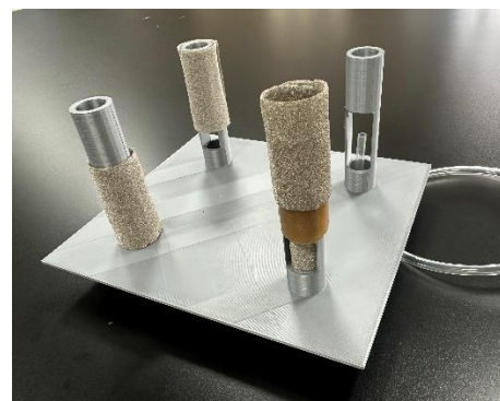
第三代製氫裝置電極拆解圖
