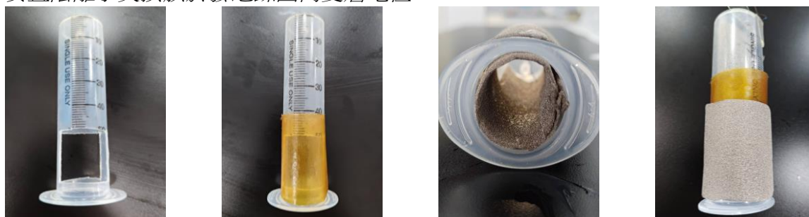
(a)針筒開洞示意圖 (b)套上離子交換膜 (c) 將發泡鎳套至內管壁 (d)整體裝置圖
