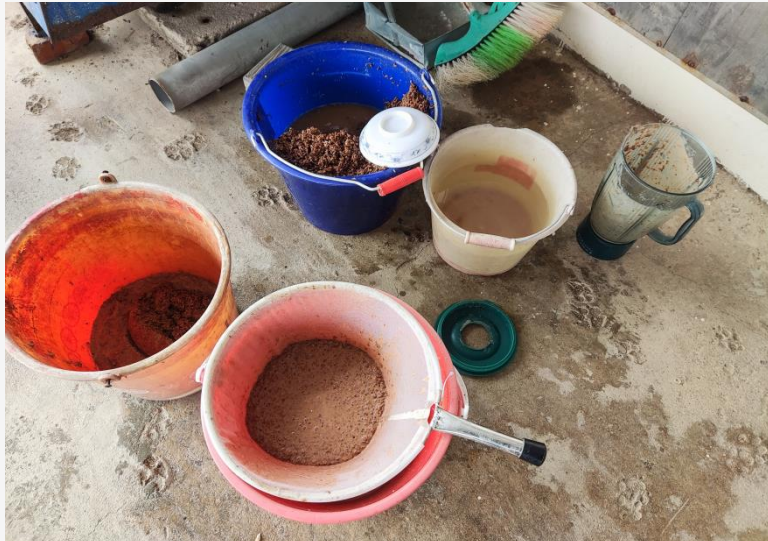
圖 5、以 56 目手抄網擠壓過濾取得高粱酒糟萃取液
