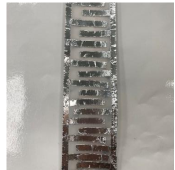
圖 14 水龍頭漏水實測實驗 銀箔磨砂間距小間隔 0.3 公分
