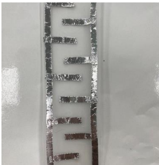
圖 12 水龍頭漏水實測實驗 銀箔磨砂間距大 間隔 1 公分
