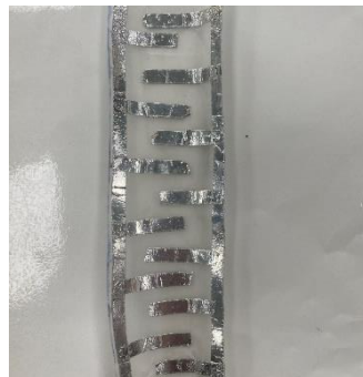
圖 13 水龍頭漏水實測實驗 銀箔磨砂間距中間隔 0.5 公分
