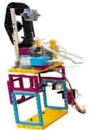
3. 清理效能試驗：依攪拌槳一、Z、H、八爪四種型，以 SPIKE 馬達動力 100%、75%、50%、25%進行攪拌，攪拌材料為 PS 塑膠 0.2mm 顆粒 5g，於 500ml 燒杯內攪拌。每秒拍攝一張並記錄攪拌混和動態。
