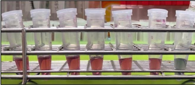
圖 5. 找到最適合的抗體濃度。抗體 D3 從高到低濃度，顏色由紅變藍。稀釋度最高但仍保持紅色的試管是最佳蛋白質濃度。因此右側的第二個試管有最佳蛋白質濃度，為 0.05 mg/mL。
